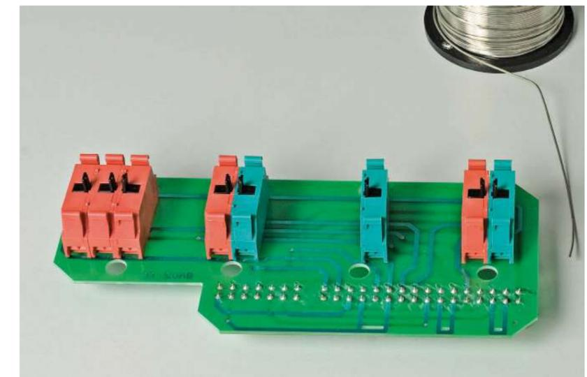
**КОНТАКТНЫЕ БЛОКИ | С ВИНТОВЫМИ ЗАЖИМАМИ**
